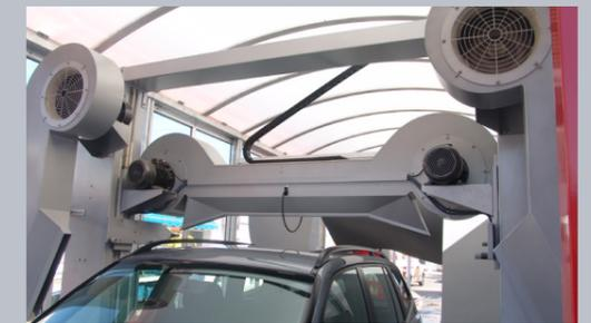
Das Trockenmodul besteht aus 4 Turbotrocknern mit einer Leistung von je 4 kW, die bei niedriger Drehzahl (1.500 U/Min) und einem hohen Luftdurchsatz arbeiten, um die Trockenleistung zu steigern. Die Dachdüse bietet mit ihrem besonderen 3D-Design eine außergewöhnliche Trocknungsqualität bei allen Fahrzeugtypen.
