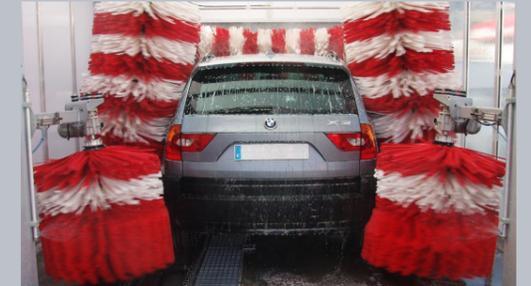
Bei Anlagen ab 12,5 Metern können zwei Konturwalzen installiert werden, um der Anlage einen Mehrwert und eine höhere Waschqualität zu verleihen.
