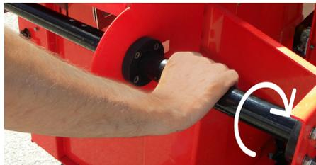
Präzise Steuerung der Anlage mit ergonomischen Steuerelementen sowie sanfte Bewegungen dank des hydraulischen Antriebssystems. Steuerelemente an Bord, um Richtung, Wasser, Drehrichtung und Neigung der Bürste zu steuern.
