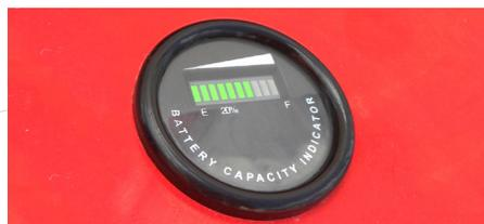
Gruppe von 24V-Batterien mit einer Lebensdauer von 1.100 Ladezyklen und externer Anzeige der Eigenständigkeit der Batterien. Mit Ladegerät neuester Generation, um die Anlage in wenigen Stunden aufzuladen und bis zu 4 Stunden lang ununterbrochen arbeiten zu können. Dies entspricht 30 kompletten Wäschen.
